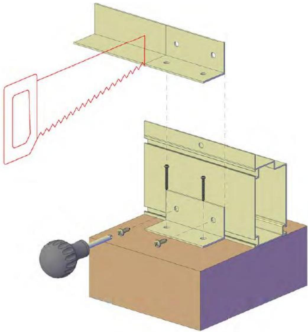
För växthus på mur/gjuten platta kapas förankringsjärnen enligt bilden ovan. Den överblivna biten kapas upp och används för att förankra bottenprofilen i muren/plattan. Använd rostfri skruv.
